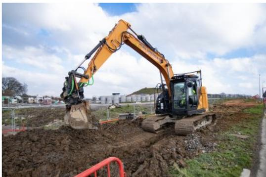
La máquina de voladizo corto de giro CX85D SR también utiliza cadenas más anchas, con tejas de 600 mm, y funciona con un brazo monobloque recto, mientras que las máquinas de 13 y 14 toneladas también disponen de cadenas anchas, con tejas de 800 mm, que aumentan sus prestaciones sobre terrenos mojados y difíciles, además de mejorar su estabilidad.
